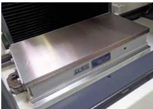
Magnetspannplatte, optional mit Spannkraftsteuerung.
