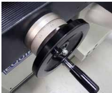
Mechanisches Handrad für den Quervorschub.
