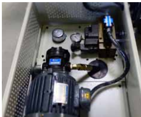
Freistehendes externes Hydraulikaggregat.
