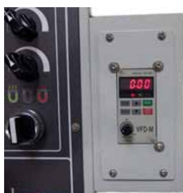
Option, stufenlose Drehzahlverstellung bis 2'300U/Min.
