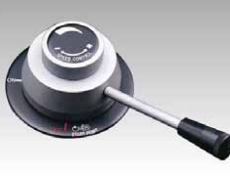
Bedienhebel für den hydraulischen Tischvorschub.
