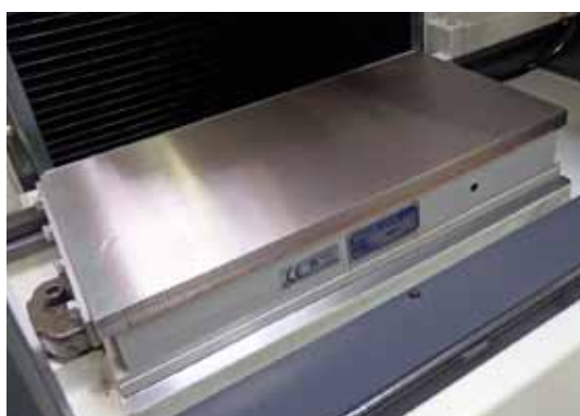
Magnetspannplatte, optional mit Spannkraftsteuerung.
