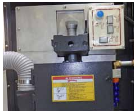
Option automatischer Kopfabrichter mit Masskompensation.
