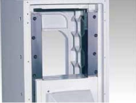
Ansicht des robusten Gussständers mit durchgehärteten Führungsleisten.
