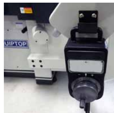
Optional, elektronisches Handrad für die Höhenverstellung
