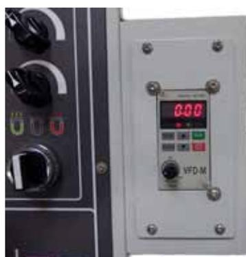
Option, stufenlose Drehzahlverstellung bis 2'300U/Min.
