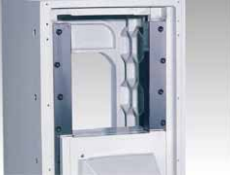
Ansicht des robusten Gussständers mit durchgehärteten Führungsleisten.
