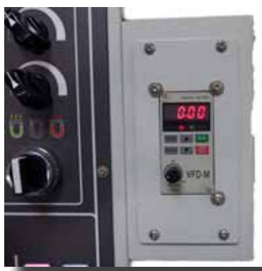
Option stufenlose Drehzahlverstellung bis 2'300U/Min.
