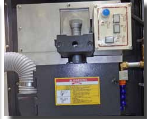
Option automatischer Kopfabrichter mit Masskompensation.
