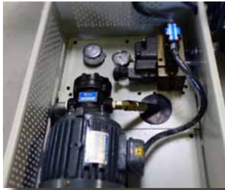
Freistehendes externes Hydraulikaggregat.
