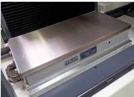
Magnetspannplatte, optional mit Spannkraftsteuerung.
