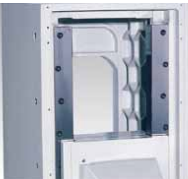
Ansicht des robusten Gussständers mit durchgehärteten Führungsleisten.
