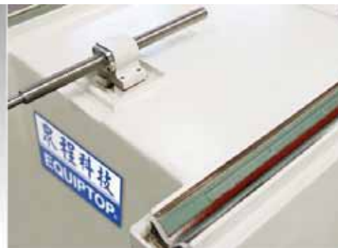
Ansicht der geschabten V-Flachführungen in der X-Achse.
