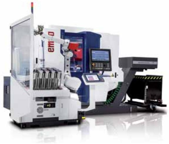
Sämtliche EMCO Drehmaschinen können automatisch beladen werden. Ob 3m Stangenlader, Kurzstangenlader, Portallader, einfache Schwenk-Ladesysteme oder Roboter-Applikation, unsere Spezialisten finden für Sie die massgeschneiderte Lösung.
