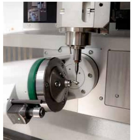
Ansicht Dreh-Schwenk Einheit mit integriertem WZ-Taster.
