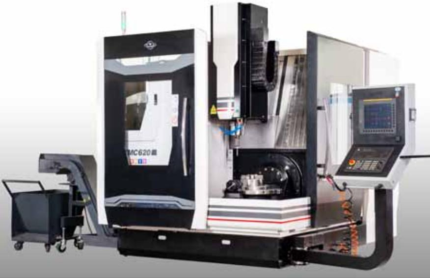
Fahrständermaschine mit Tischabstützung an der Front.
