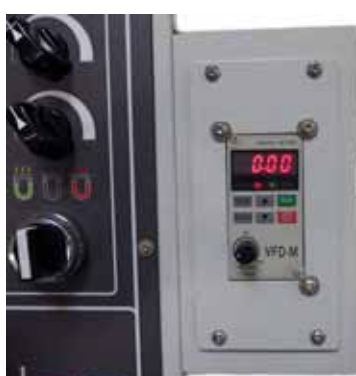
Réglage continu de la vitesse jusqu'à 2300 t/min
