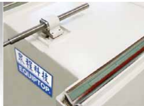
Guides en „V“ grattés et revêtus en TURCITE B de l'axe X.
