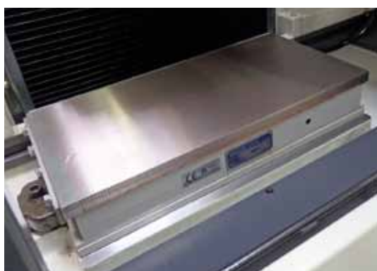
Plateau électro-permanent avec en option réglage de la force.
