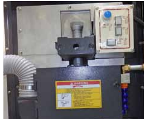
Option automatischer Kopfabrichter mit Masskompensation.
