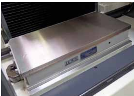
Magnetspannplatte, optional mit Spannkraftsteuerung.
